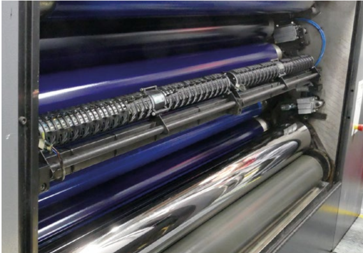
Potenzial erkannt: LotoTec-MRS-Farbwalzen von Westland sind seit Jahren eine Konstante im Druckprozess der Karl Knauer KG
