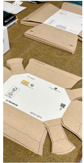
Ob im Akzidenz- oder im Verpackungsdruck – mit den Rotationsstanzen von Bograma lassen sich raffinierte Stanzungen realisieren.
