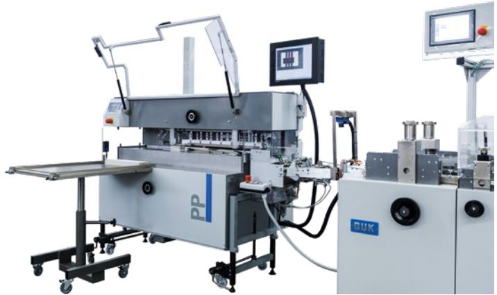
Automatisches, modular aufgebautes Abpacksystem Pick & Pack PP600 von GUK für die Packungsbeilagen „Outserts“ oder „Booklets“.
