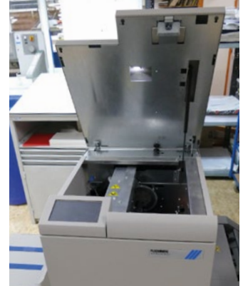
Der Plockmatic SquareBack-Trimмер kann auch für die Broschürenfertigung offline verwendet werden.
