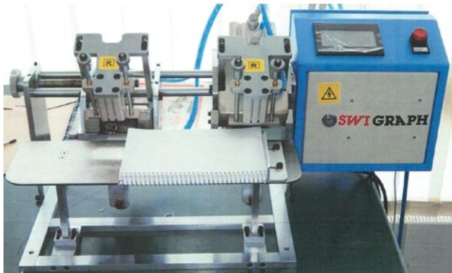
Einen einfachen aber effizienten **Auto-CRIMPER**, versieht beide Spiralenden mit einem **Doppelbug** (Krimp). Verarbeitet A6 bis A4 Hefte mit einer Stundenleistung von 350 bis 450 Hefte/Std.
