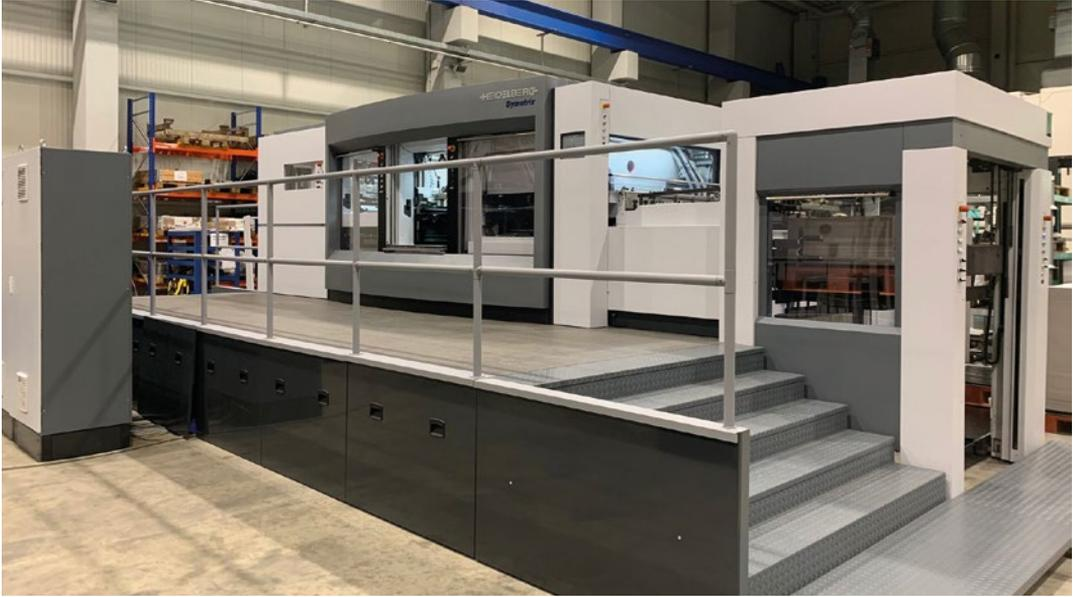
Quasi wie neu: eine vollständig von QTM überarbeitete und mit eigenen Innovationen erweiterte Dymatrix-Stanze von Heidelberg. Bevor sie zum Kunden geht, erfolgt dort vor Ort immer erst eine technische Analyse zur Rüstzeitreduzierung.
