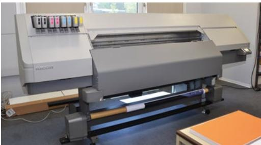
Die Ricoh Pro L5160e ist ein Großformatdrucker, der die Latextinten-Technologie verwendet.
