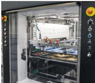
Als Innovation in die Stanze integriert: Der robuste QTM-Schnellspannrahmen macht schnelle und reibungslose Werkzeugwechsel möglich. QTM garantiert eine langfristige Ersatzteilverfügbarkeit.
