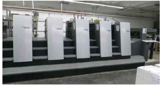
Eine mit Prinect Production Manager und Prinect Inpress Control ausgestattete Speedmaster XL 75-5 + Lack wurde von Paradowski bei bauerprint im Juli 2018 eingebracht.
