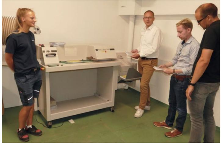
Die DocuPunch-Plus-Stanzmaschine (links) und der halbautomatische Wire-O-Bind 3000 von James Burn International (JBI) ermöglichen alle Arten von Wire-O-Bindungen für eine Vielzahl von Dokumenten.
