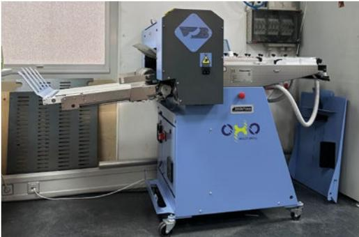
Bereits im Frühjahr 2023 installierte binderhaus die erste Rill- und Falzmaschine OXO Multiskill bei Bühler, deren Leistung von bis zu 9.000 Bogen/h überzeugte. Vier Monate holte man sich eine zweite, identische Maschine ins Haus.
