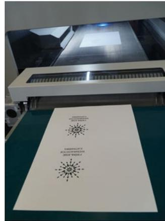
Die Verarbeitungsgeschwindigkeit des Motioncutter hängt wesentlich von der Kontur des Motivs ab. Von diesem Testbogen mit Schriftzug und einer komplexen Sternform mit schmalen Stegen schafft die Maschine rund 450 Bögen pro Stunde.
