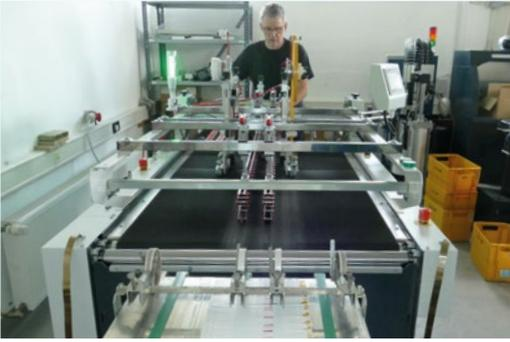
Mit nur einer Person kann die Athos Plus inkl. anschließender Banderolierung der fertigen Produkte bedient werden.
