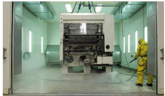
Bevor man mit der Überholung der Gebrauchsmaschinen beginnt, erfahren die Produktionssysteme erst einmal eine Grundreinigung in der firmeneigenen „Reinigungskabine“.
