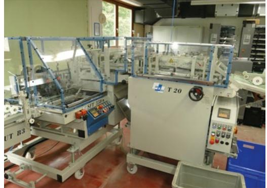
Baumann sorgte bei Braun für die Einbringung der MKW-Zusammentragmaschine Rapid UT16/B3/GS, dem Heft-Falz-Aggregat MKW Rapid SFT350 mit Frontbeschnitt und dem Kopf- und-Fußbeschnitt-Aggregat MKW Rapid T20.
