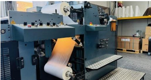
Die Laminiermaschine Autobond Mini 53 TPH VS laminiert ein- oder zweiseitig mit bis zu 60 Meter/Minute.
