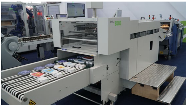
Die automatische Einzelbogenauslage mitra kann verschiedene Produkte gleichzeitig sammeln, stapeln und ausgeben, so wie sie aus der hier vorgeschalteten Bograma-Stanzmaschine übergeben werden.
