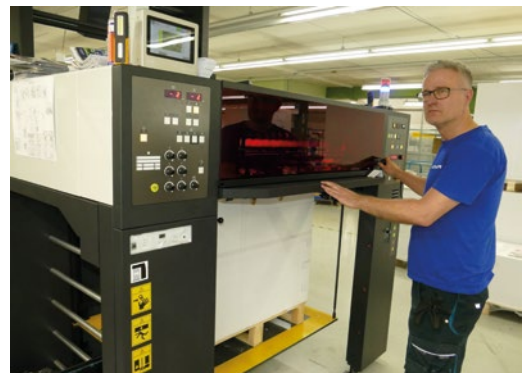
Schnell zum neuen Job: Die neue Komori GL-837P LED besticht unter anderem durch A-APC + Parallel Makeready: Druckplattenwechsel, Gummituchreinigung, Farbprofilaufbau sowie die Voreinstellungen für Luft und Register laufen mithilfe von Parallel Makeready simultan in gerade einmal zwei Minuten.
