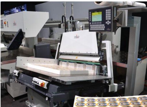
Etiketten-Bogen rütteln für das Vorschneiden in Streifen zum Finishing im Polar LabelSystem DC-12 Plus.
