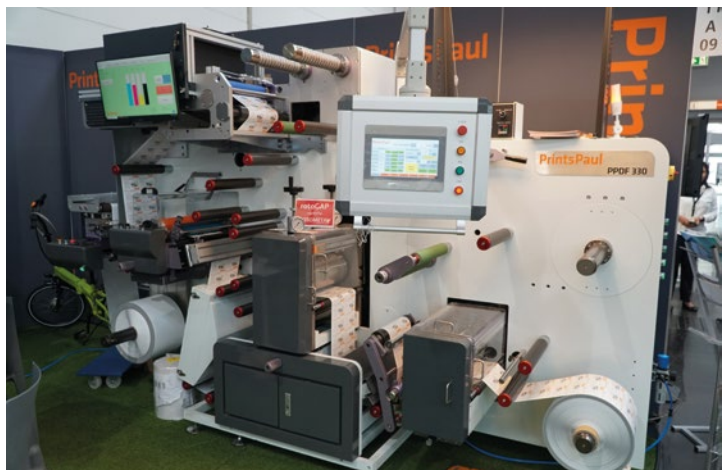
Der kompakte PPDF 330 ist bei PrintsPaul-Kunden überaus beliebt und auch als PPDF 420 mit bis zu 420 mm Bahnbreite verfügbar. Neu ist die Möglichkeit, ein Vierfarb-Inkjetmodul (hier links oben) zu integrieren.
