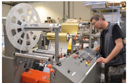
Einfach zu bedienen: Das engagierte Schleppers-Team in der Produktion hatte den Bagel RSR und das Sleeking von digital gedruckten Produkten auf Rolle schnell „im Griff“.
