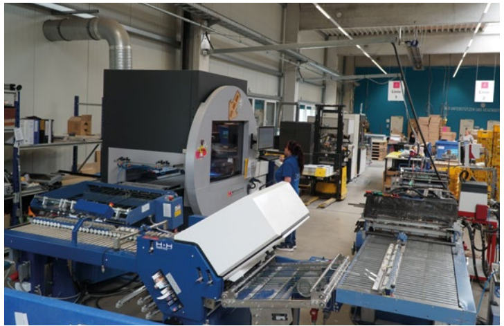
Inline-Produktion von Direct Mailings mit dem Motioncutter. Die Mailings werden mit dem Laser „gestanzt“, anschließend gefalzt und für den Versand ausgelegt. Die Produktionsstraße soll durch neue Module erweitert werden.
