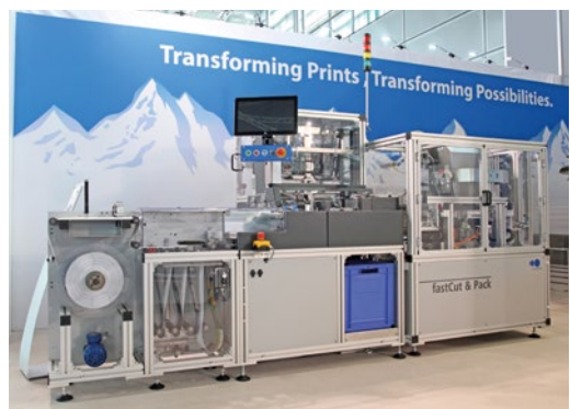
Mit der fastCut & Pack lassen sich Fotodrucke in Hochgeschwindigkeit automatisch schneiden und verpacken.
