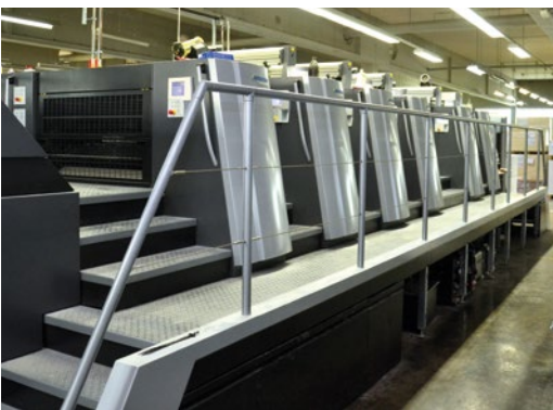
Produktivitätssprung: 18.000 Bogen pro Stunde schafft die Maschine im Schön- und Widerdruck.
