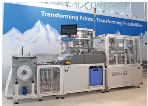
Mit der fastCut & Pack lassen sich Fotodrucke in Hochgeschwindigkeit automatisiert schneiden und verpacken.
