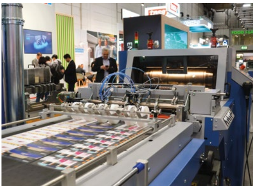
Die rotative Stanzmaschine BSR 550 Servo von Bograma wurde während der drupa als Teil einer Produktionslinie für Flyer präsentiert.
