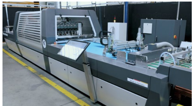
Zu groß für den drupa-Messestand: das neue digitale Druckveredelungssystem Hammerhead 76/106 der Kama GmbH.
