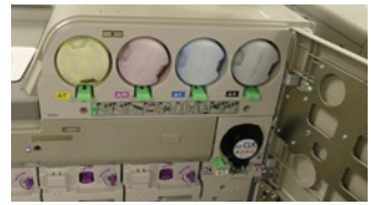
Langbögen mit bis zu 1.260 mm Länge sowie die Bedruckung mit einer fünften Farbe (hier u. r. der Klartoner) sind Features der C7500.
