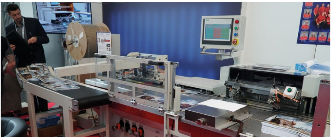
Die Magnopro Bind 580 S wird inklusive einer Bandauslage geliefert. Sie ermöglicht die automatische Schuppenauslage inline oder in einem 90-Grad-Winkel. Die Taktzahl der Maschine liegt bei 1.500 Stück pro Stunde.
