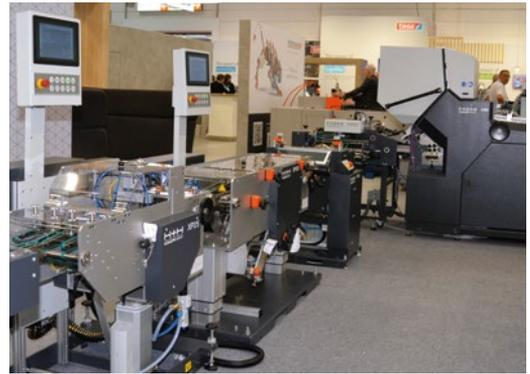
**Kleinstfalzungen mit der M9 von H+H (rechts) samt peripherer Weiterverarbeitung. Die Fähigkeit der Maschine, Kreuzbrüche per Messerfalz auszuführen, ist patentiert.**
