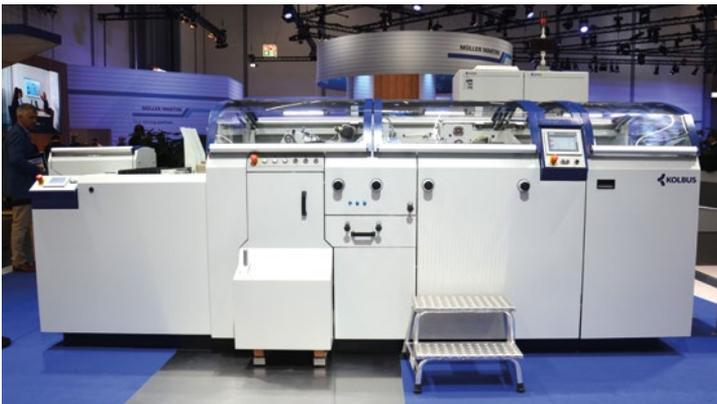
Die Buchdeckenmaschine Kolbus DA 160 ist mehr als nur die „kleine Schwester“ der DA 270. Die Marktausrichtung ist eine andere und mit dem matrizenfreien Leimwerk verfügt sie auch über ein ganz besonderes technisches Highlight.
