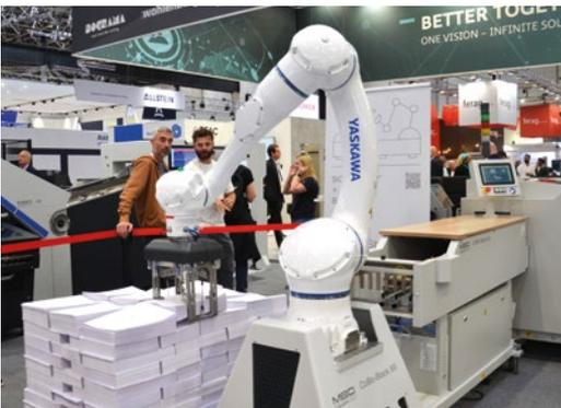
Der CoBo-Stack 30i feiert auf der drupa seine Premiere, er soll Ende des Jahres kommerziell verfügbar sein. Als Cobot kommt ein Roboterarm von Yaskawa zum Einsatz.
