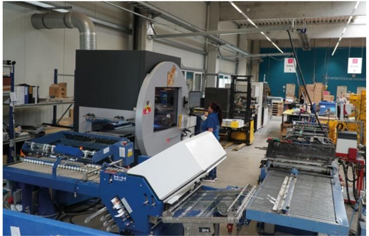
Anlage im Schnitt auf über 200.000 Exemplare. Inline-Produktion von Direct Mailings mit dem Motioncutter. Die Mailings werden mit dem Laser „gestanzt“, anschließend gefalzt und für den Versand ausgelegt. Die Produktionsstraße soll durch neue Module erweitert werden.
