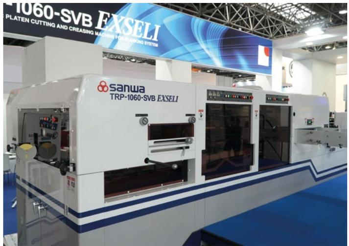
...problemlos Papier und Karton mit Flächengewichten von 80 bis 2.000 g/m<sup>2</sup> sowie Wellpappe bis zu einer Dicke von vier Millimeter.
