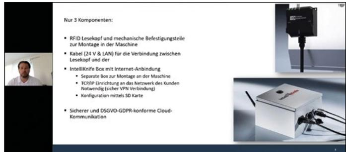
Das IntelliKnife-System besteht lediglich aus drei Komponenten. Deshalb können auch ältere Schneidmaschinen relativ leicht nachgerüstet werden.
