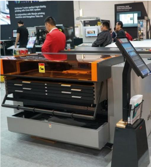
Variable und schnelle Produktion dank Multiloader: Fünf Plattenformate können vollautomatisch für verschiedene Druckmaschinen ausgegeben werden.
