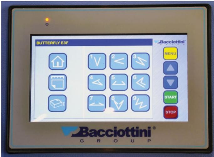
Das vereinfachte HMI-Panel von Bacciottini, das es auch ungelernem Personal schnell ermöglicht, die butterfly Rill-/Falzmaschinen zu bedienen.
