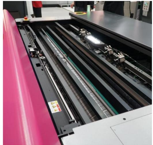
Blick auf Laser-Array, Belichtungstrommel und integrierte Registerstanzung des 72-Zoll-Belichters für Plattenbreiten bis 1.860 mm. Alle Cron-Belichter verfügen über 2.400, 2.540 oder 2.800 dpi Auflösung, optional bis 10.160 dpi.
