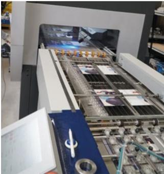
Die genaue Übergabe der Bögen vom Anleger auf das spezielle Saugband des Motioncutter sorgt für Präzision beim Lasern. Das Transportband selbst muss nur selten gewechselt werden.
