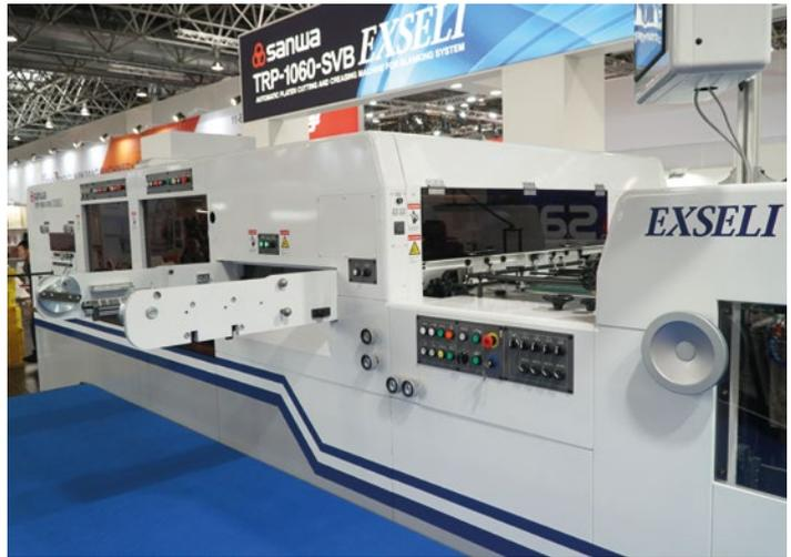
Die Exseli ist das Topmodell des japanischen Stanzmaschinenherstellers aus Hiroshima. Mit ihrer Stanzkraft von maximal 300 Tonnen verarbeitet sie...
