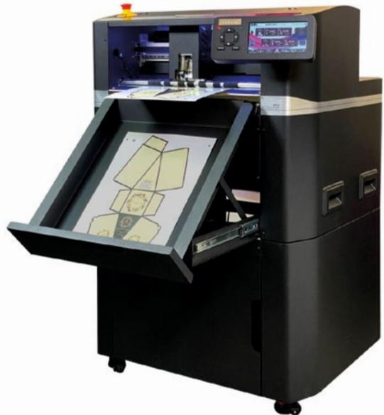
Der SC 7000 Pro ist auch mit zwei Werkzeugen ausgestattet, verfügt aber über eine tangentielle Radrilleinrichtung, um auch bis 450 mic. starkes Material sauber zu rillen.
