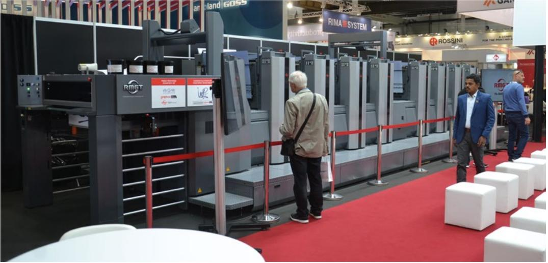
Im Bereich Akzidenzdruck stand die RMGT 970PF-8 als Achtfarben-Perfektor im Mittelpunkt. Der aktuelle Topseller von Ryobi im A1-plus-Format demonstrierte seine fortschrittlichen Automatisierungsfunktionen.
