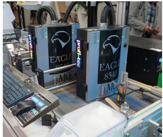
Die MSC-Eagle-Druckeinheiten lassen sich zu Duplex-Einheiten kombinieren. Die verwendeten Hybridtinten benötigen bei saugfähigen Substraten keinen Trockner.
