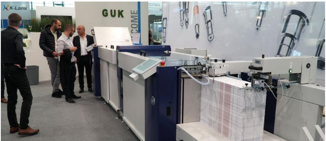
Der neue Hochleistungsfalzautomat FSA 52/85-Net von MB Bäuerle verfügt über einen Flachstapelanleger mit Netzsteuerung und Ultraschall-Doppelbogenkontrolle sowie einen automatischen Ausrichtetisch.
