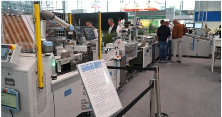
...demonstrieren dies mit dieser automatisierten Outsert-Produktionslinie auf Basis des FA53-Multitaschensystems (im Hintergrund).
