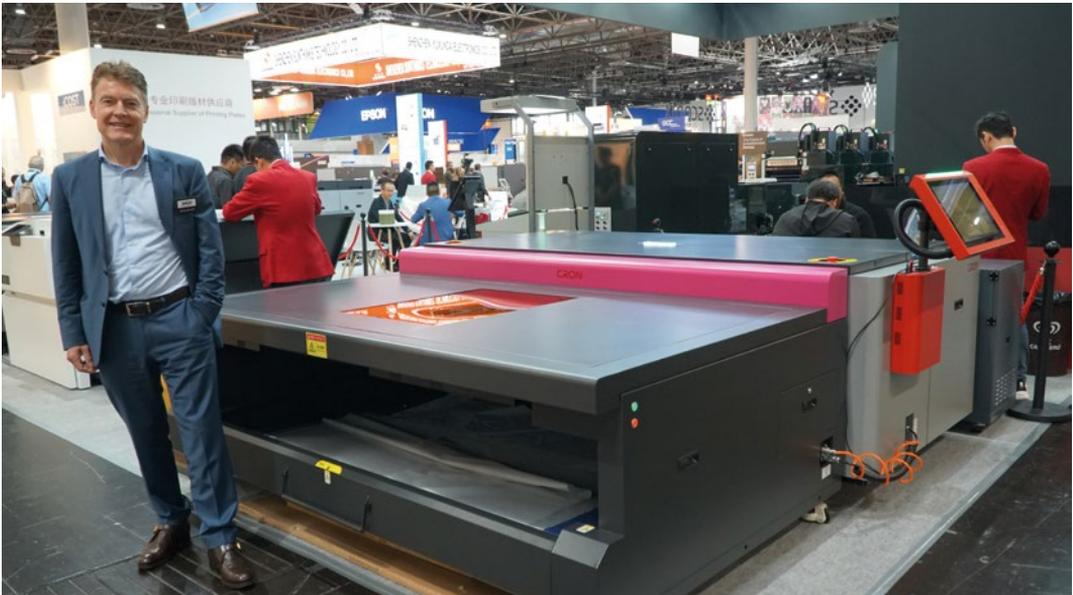
Martin Hartmann mit 72-Zoll-Belichter in sehr kompakter Bauweise: Der Vollautomat kann Platten bis 1.860 x 1.422 mm registergestanz ausgeben und verfügt über einen Autoloader für 100 Druckplatten 0,40 mm mit automatischer Zwischenlagepapierentfernung. Mittels Trolleys können die Plattenformate vom Bedienpersonal getauscht werden.
