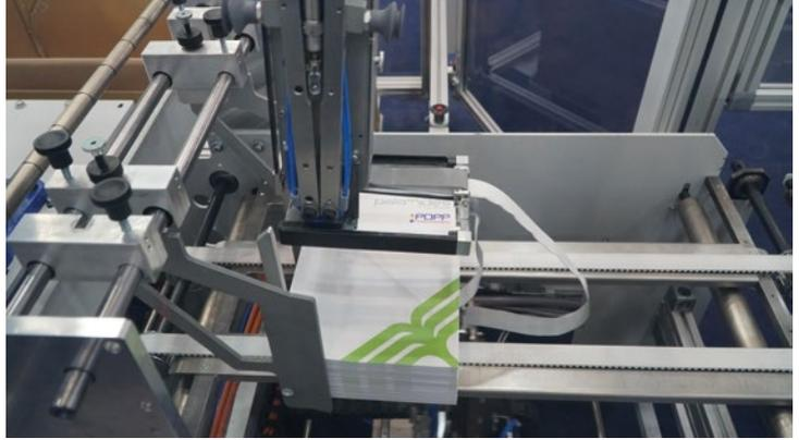
Der zum Patent angemeldete Bandgreifer von palamides verwendet eine Bandschleife zur Aufnahme der Pakete. Dadurch lassen sich diese eng aneinander stapeln. Das spart Platz und sorgt für sicheren Halt im Karton.
