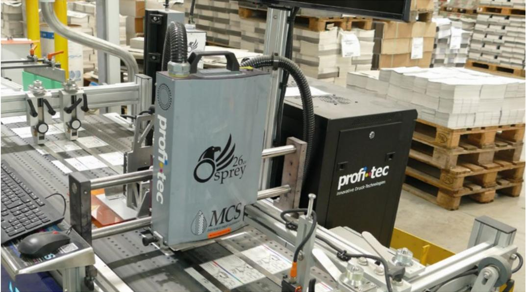
Die vollautomatische Produktionsstraße, deren Herzstück das System MCS Osprey mit einem leistungsstarken UV-LED-Trockner bildet, wurde im Frühjahr 2023 von profi-tec bei Stark Druck für den variablen Datendruck installiert.
