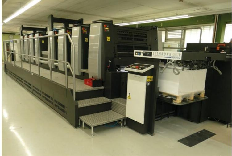
Die bei Braun Druck & Medien installierte Komori Lithrone G-837P LED harmoniert sehr gut mit den begrenzten Räumlichkeiten im Drucksaal. Die Maschine bietet die hochwirtschaftliche 16-Seiten-Produktion im A4-Format im 4-über-4 bis zur maximalen Druckgeschwindigkeit von 15.000 Bg/h. Der geringe Energiebedarf der Maschine senkt zudem die Kosten.
